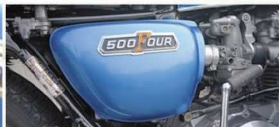
De luchtgekoelde 498 cc viercilinder leverde 48 pk bij 9.000 tpm, een voor die tijd ongekend hoog toerental. De vier Keihin-carburateurs bleven standaard, de vier uitlaten werden vervangen door een 4-in-1-exemplaar.
