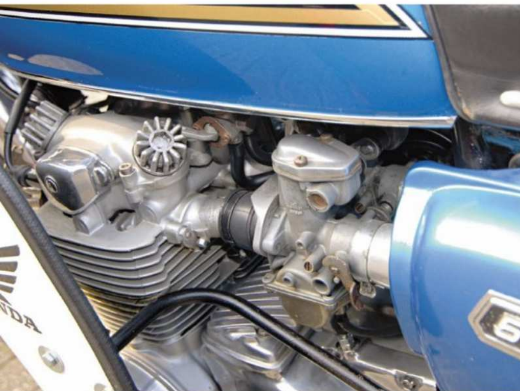
De luchtgekoelde 498 cc viercilinder leverde 48 pk bij 9.000 tpm, een voor die tijd ongekend hoog toerental. De vier Keihin-carburateurs bleven standaard, de vier uitlaten werden vervangen door een 4-in-1-exemplaar.
