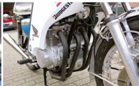
De luchtgekoelde 498 cc viercilinder leverde 48 pk bij 9.000 tpm, een voor die tijd ongekend hoog toerental. De vier Keihin-carburateurs bleven standaard, de vier uitlaten werden vervangen door een 4-in-1-exemplaar.
